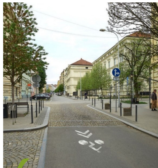
Obrázek 5 – Fyzické prvky zklidnění vybudované v rámci rekonstrukce (ul. Gorkého)
