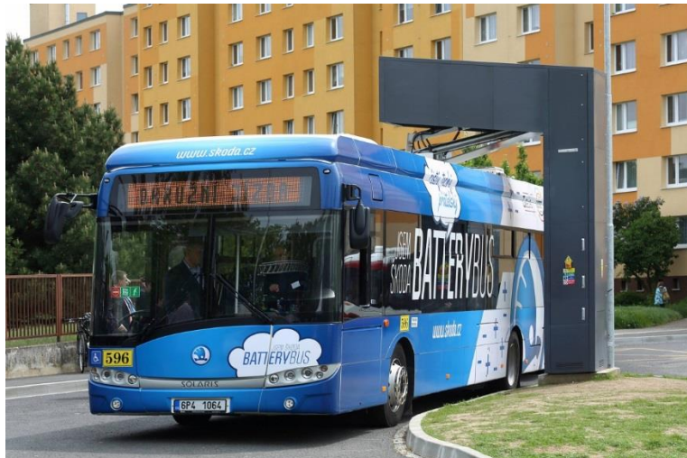
Obr. 30: Ukázka vozidla Škoda Perun HP s dojezdem 30 km, nabíječka 600 kW, doba nabití do 8 min.
