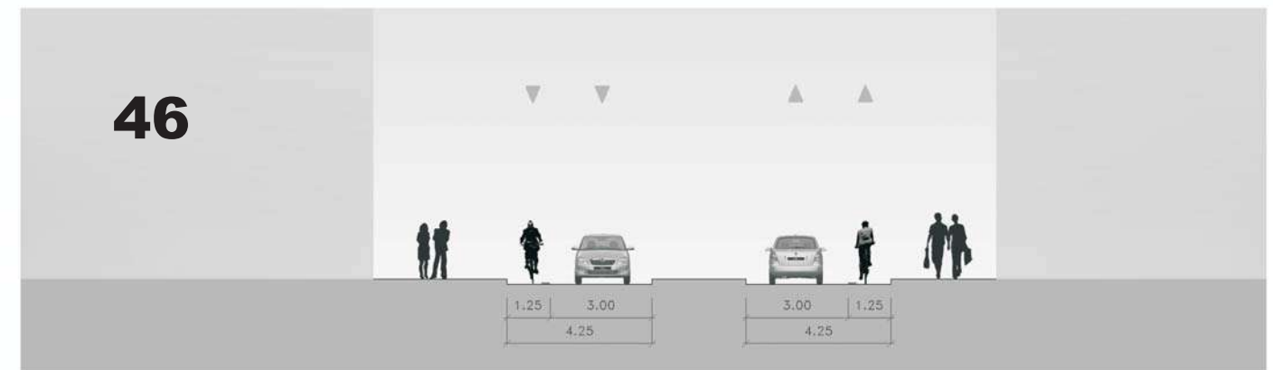
VZOROVÝ ŘEZ LOKÁLNÍ ZÚŽENÍ (NAPŘ. OCHRANNÝ OSTRŮVEK) NA MS2a
