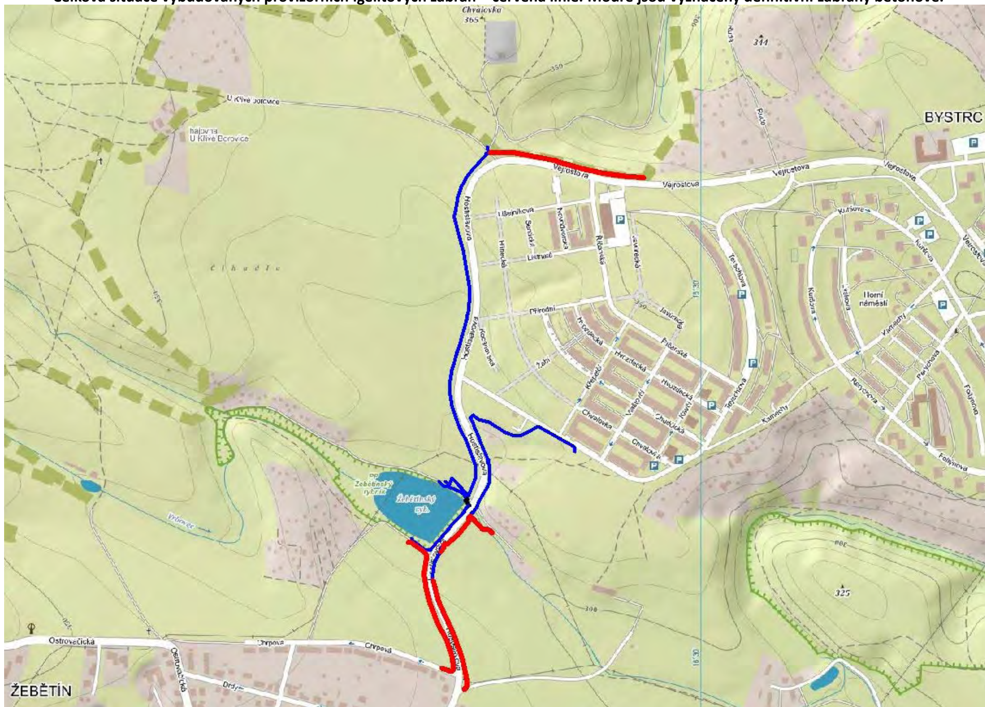
Celková situace vybudovaných provizorních igelitových zábran – červená linie. Modře jsou vyznačeny definitivní zábrany betonové.
